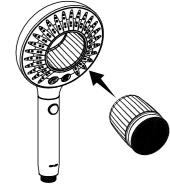
将洁面仪插入手持花洒。 Insert the cleansing device in the handshower. 安装说明
